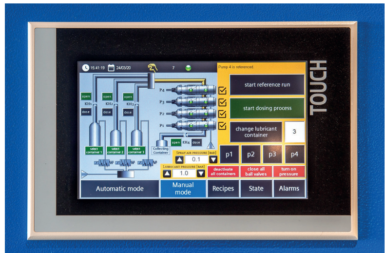
Steuerung Dosiergerät – Status
