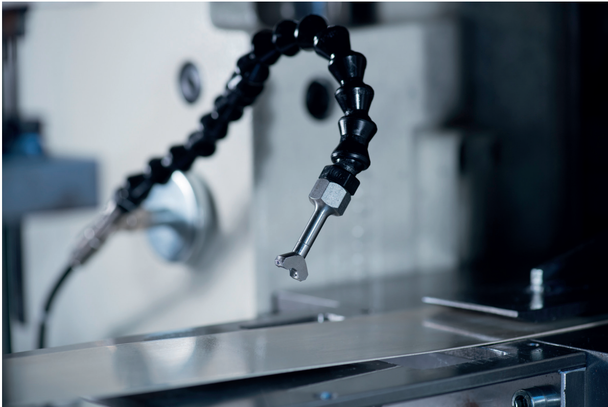
Bild: Die Anzahl der nebeneinander geschalteten Dosierdüsen, hier mit Flachstrahlaufsatz, bestimmt die maximale Sprühbreite (Werkbild: Werucon GmbH, Bremen)
